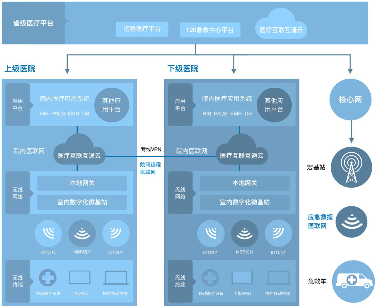
**院内医联网。**通常采用“室内小站+本地网关”解决方案。室内小站是指室内建设的数字化分布式微功率基站；本地网关是室内无线组网的业务锚点，包含智能路由、能力开放和联接管理等 MEC 功能，实现虚拟专网控制。
