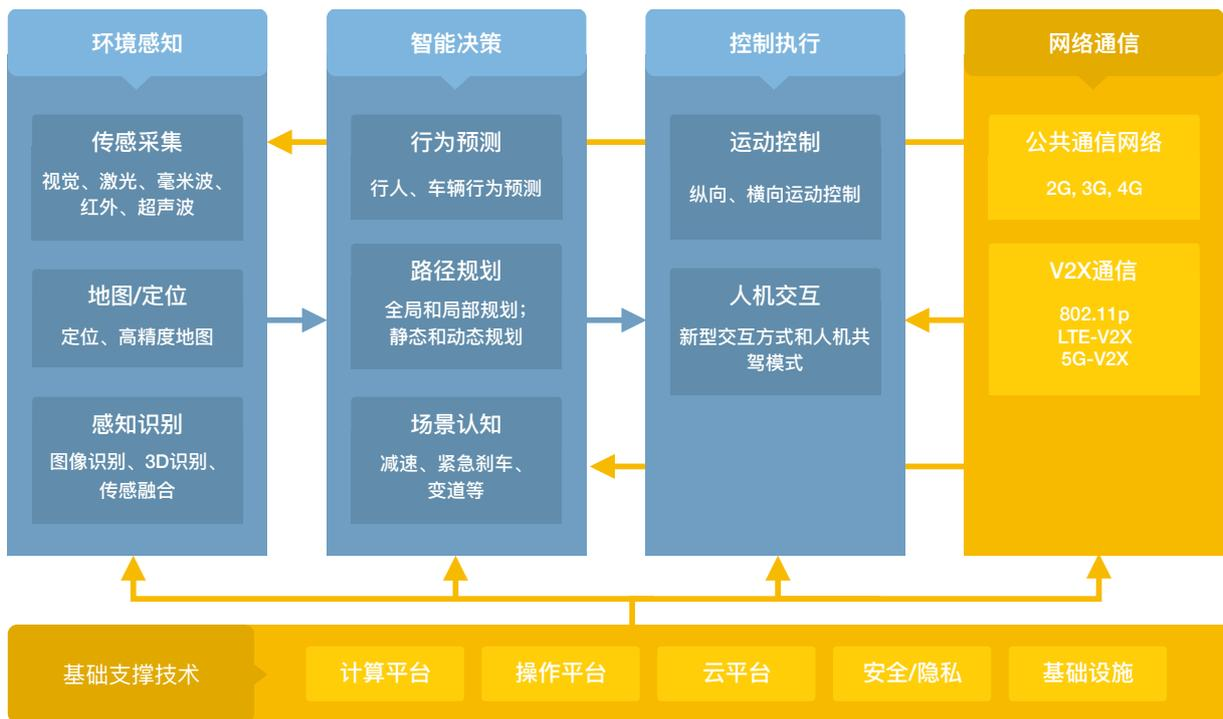
**智能技术。**智能网联汽车包括环境感知、智能决策、协同控制三大系统。支撑环境感知的装置和技术主要包括车载单车传感器，如包括各种雷达、摄像头、加速度传感器等，并通过通信以及网络技术（包括蜂窝移动通信、V2X 通信以及精准定位技术等）获得更大的感知范围以及融合多种感知信息的多种传感器融合技术等，以实现车与 X（人、车、路、云等）智能信息交换、共享，具备复杂环境感知、智能决策、协同驾驶等功能，实现“安全、节能、高效、舒适”行驶。
